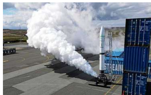
Die Rakete SR 75 kann ganz schön qualmen! Als Treibstoff dienen Kerzenwachs und flüssiger Sauerstoff.
