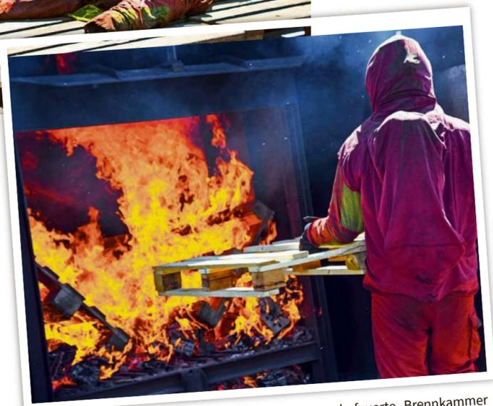
Die mit Holzpaletten befeuerte Brennkammer sorgt für Temperaturen um die 300 Grad.
